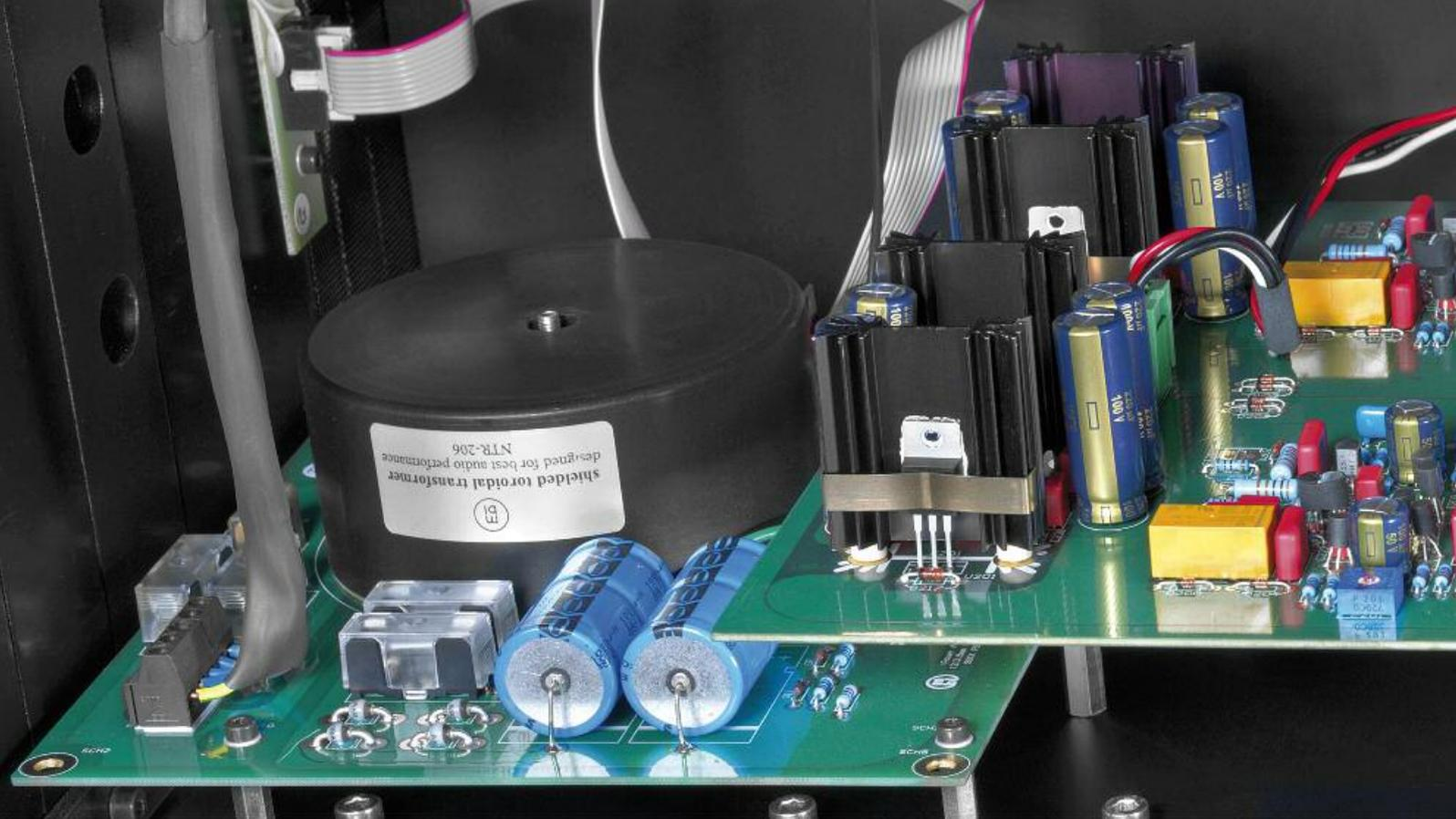
Geregeltes Netzteil für die Spannungsverstärkerplatine: links unten die Trafoplatine mit Ringkerntrafo, Gleichrichter, Ladeelkos und Sicherungen, die über einen Steckverbinder hoch zur Spannungsverstärkerplatine führt. Auffallend die vier schwarzen Kühlkörper für die linearen Spannungsregler
